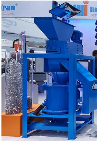
Auf unserem Stand präsentieren wir eine kompakte Späneaufbereitungsanlage. Diese besteht aus einem Spänezerkleinerer der Baureihe MA 4.1 und einer Spänezentrifuge der Baureihe VBU. Diese Anlage steht an einer oder mehreren Werkzeugmaschinen zum Trennen der Späne von Kühlschmierstoff. Der vorgeschaltete Spänerzerkleinerer kürzt die Späne für die weitere Verarbeitung. Dieses Modell hat außerdem eine automatische Grobteilseparation, die für eine hohe Verfügbarkeit des gesamten Systems steht.
